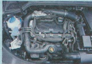
Fürs Foto abmontiert: der Motor des 1.9 TDI ohne Kunststoffdeckel
