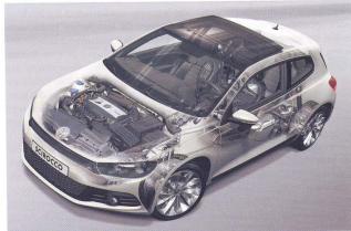
Bild 9: Alle Motoren im Scirocco sind hoch aufgeladen; die Auswahl umfasst drei TSI-Motoren und einen TDI-Motor
