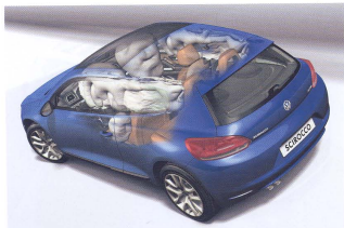
Bild 8: Zur Airbagausstattung gehören Fahrer- und Beifahrerairbags, Kopf- und Seitenairbags
