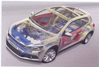
Bild 7: In der Karosseriestruktur erhöhen formgehärtete, höchstfeste Bleche für größere Festigkeit und Steifigkeit
